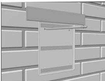
Das Rückteil des Hausnummernschild an der gewünschten Position grade ausrichten und die Bohrlöcher markieren.
