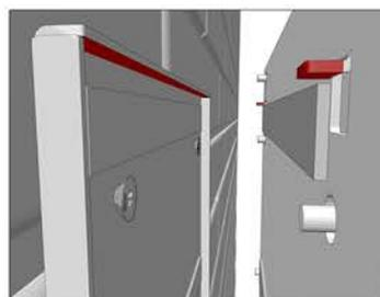
Hausnummernschild auf das Rückteil setzen. Dabei darauf achten, dass die rückseitigen Laschen in den Rahmen greifen. So kann der Druckverschluss sicher einrasten.
