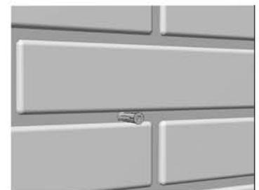
Dübel in die Bohrlöcher einsetzen.
