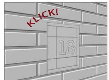
Hausnummernschild gut andrücken. Beim einrasten des Druckverschlusses sollte ein Klick zu hören sein. Vor dem loslassen, sollte kurz geprüft werden, ob das Schild fest sitzt.
